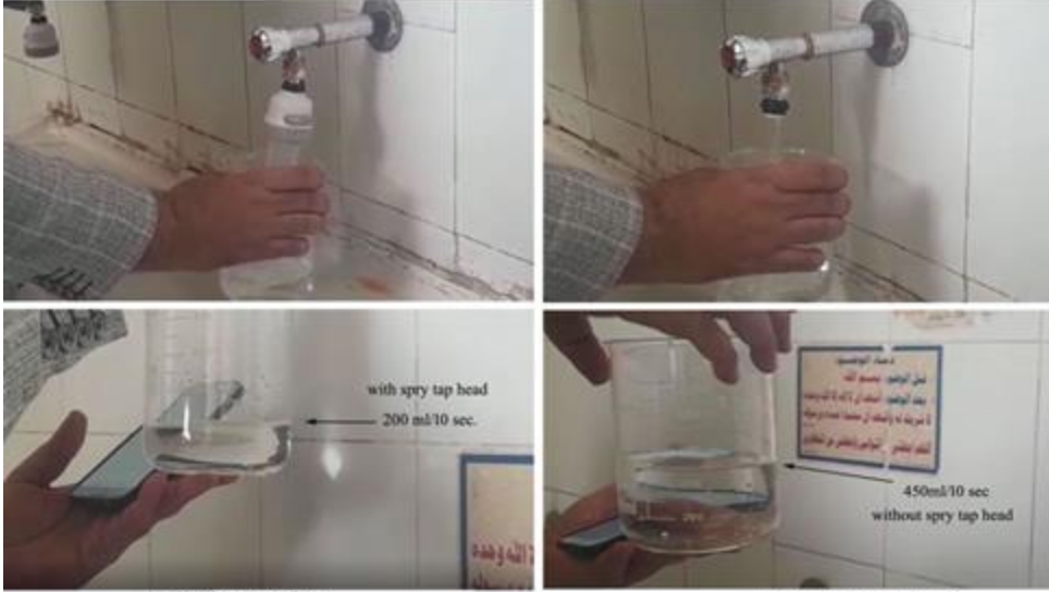
كمية المياه المتدفقة من الصنبور في وجود الوصلة الموفرة للماء خلال 10 ثواني = 200 مللي كمية المياه المتدفقة من الصنبور بدون الوصلة الموفرة للماء خلال 10 ثواني = 450 مللي صورة (2)
